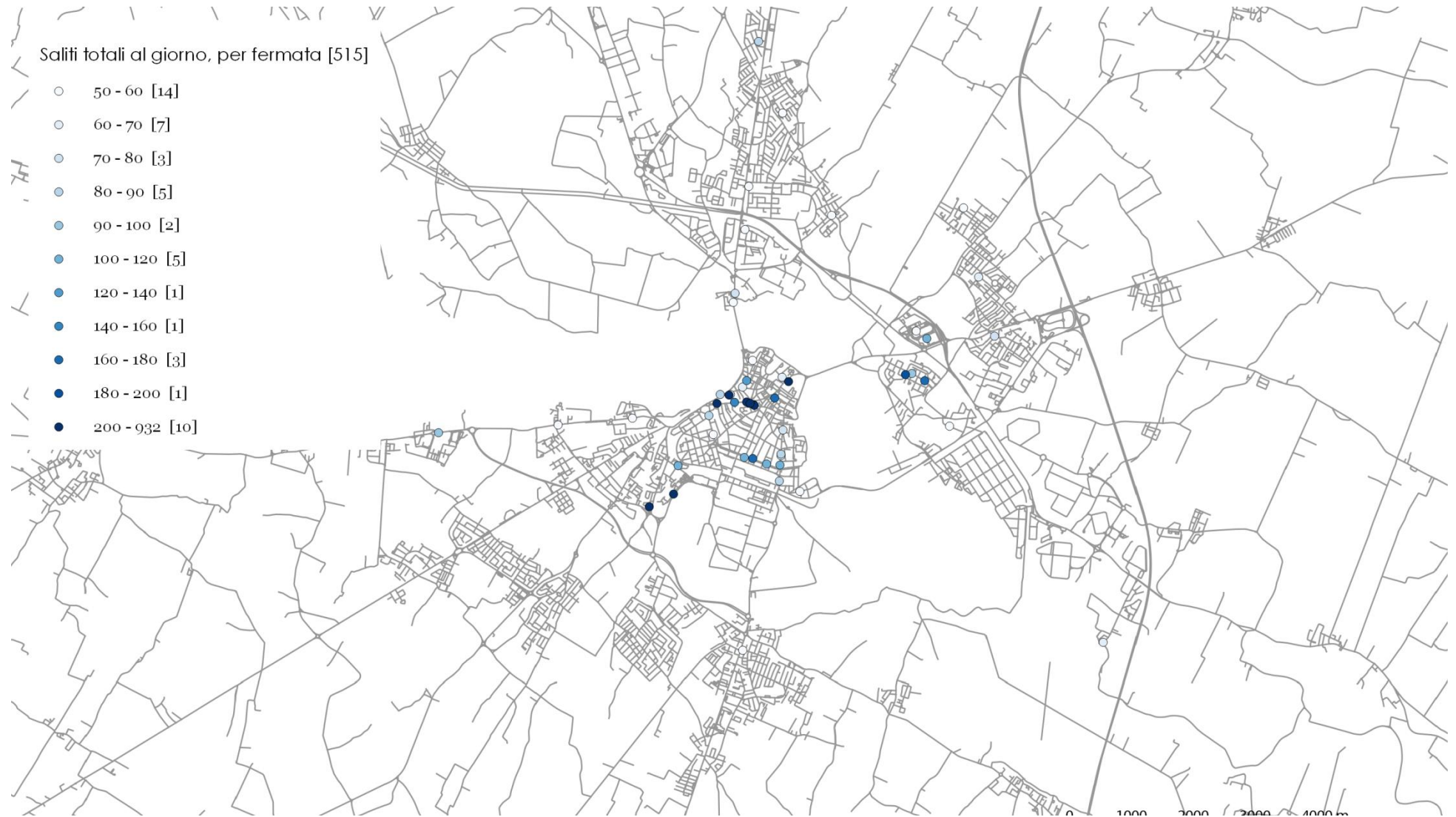
Figura 63: Saliti al giorno, per fermata. Solo le fermate con più di 50 saliti/giorno
